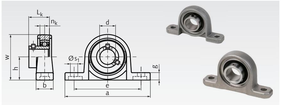
Bestellangaben: z.B.: Art.-Nr. 625 608 00, Kugel-Stehlager KP 08, Bohrung 8mm
