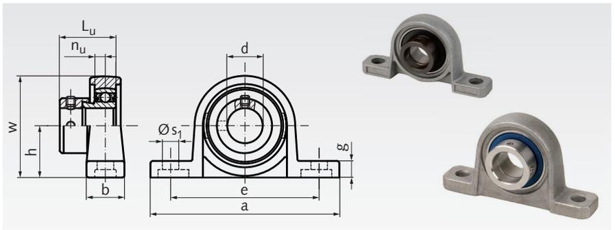
Bestellangaben: z.B.: Art.-Nr. 625 710 00, Kugel-Stehlager UP 000, Bohrung 10mm
