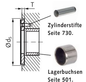
Die Anlaufscheibe muss gegen Mitdrehen gesichert werden. Sie kann z.B. verstiftet oder geklebt werden.
