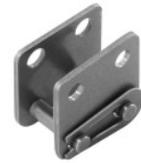
Bei ungerader Laschenanordnung **3 x p** wird ein gekröpftes Verschlussglied **Nr. 15/C** benötigt. **Ab 5 x p** kann ein gerades Verschlussglied **Nr. 11/E** eingesetzt werden.
